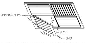
TO REMOVE - COMPRESS SPRING CLIPS & LIFT END FROM SLOT
